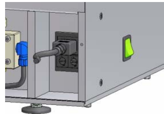
Illustration 3. Prise de courant, fusible et commutateur principal
